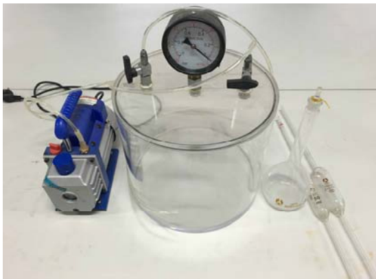
图 4 比重瓶与真空干燥器 Fig.4 Pycnometer and vacuum dryer
