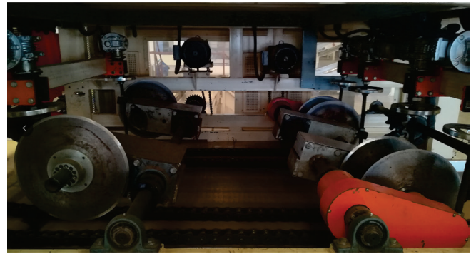
图 4 在线分切设备实体结构图
