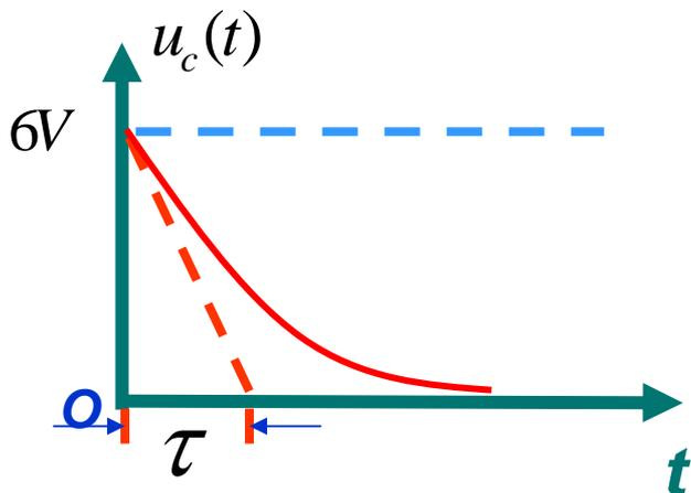
**解：**此为求电路的零输入响应
