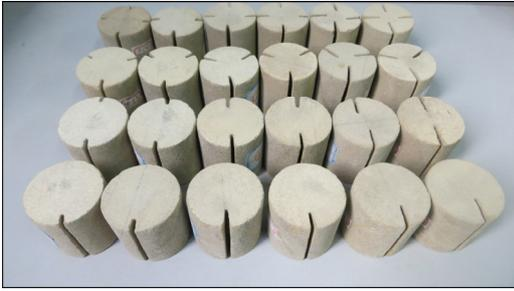
图 1 含表面裂隙砂岩试样
