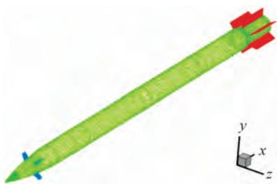
图 2 炮射飞行器外形全局网格图
