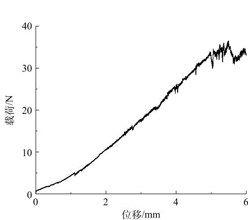
图 6 导电 CNT-PVDF 复合中空纤维膜拉伸强度测试
