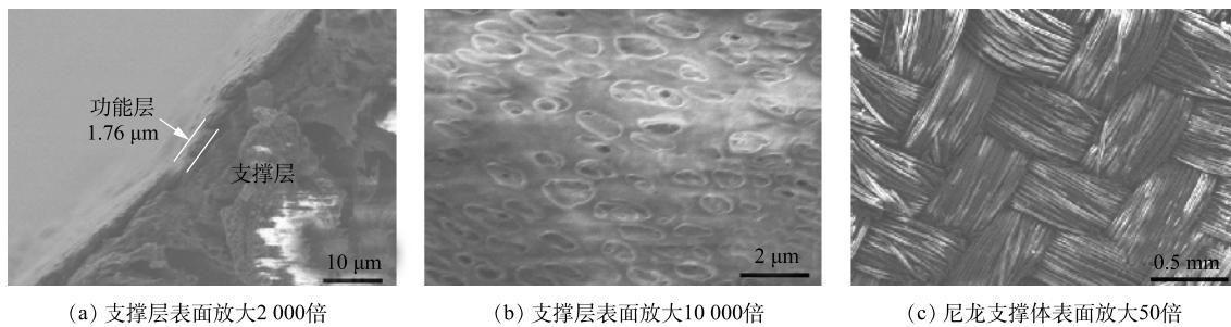
图3 导电 CNT-PVDF 复合中空纤维膜电镜图
