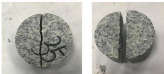
图2 巴西劈裂法试验后标准试件破坏情况
