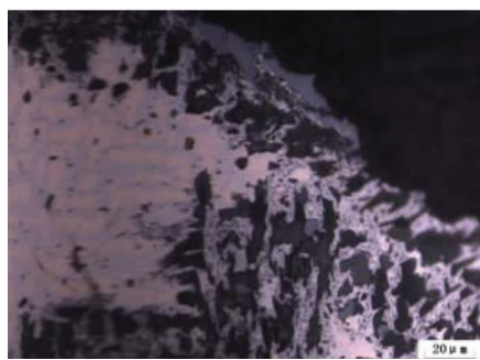
图 7 铜镜侵蚀前金相组织(C区)
