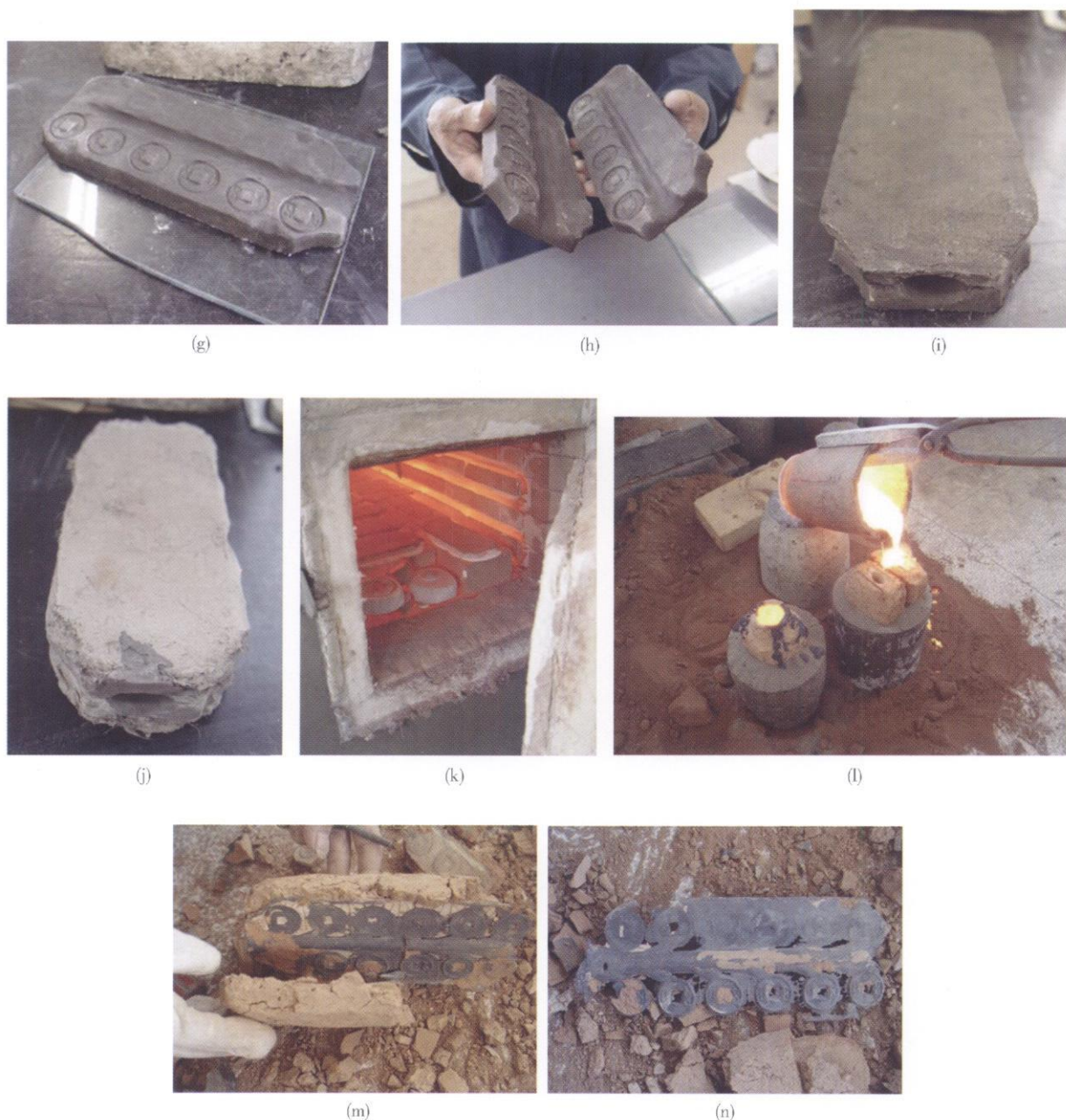
图 12 平板陶范竖式浇铸法铸钱模拟试验的工艺流程
