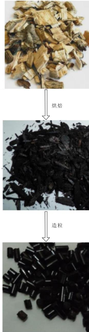
图 2 烘焙和颗粒成型后生物质外观变化
