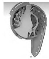
图6 导向式投种结构
