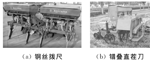
图 2 主动式秸秆防堵产品结构
