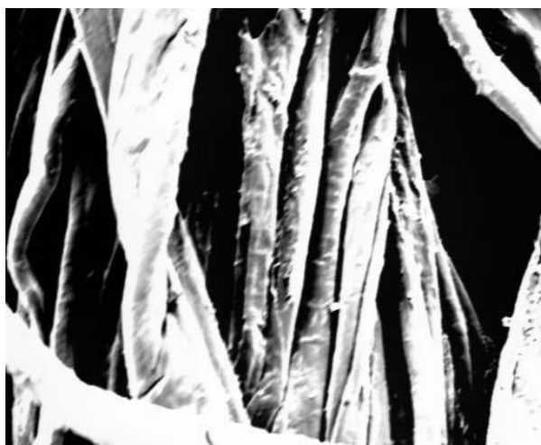
图 2d PVA 上浆的棉纤维经两次冷水和热水洗 (放大 700 倍)
