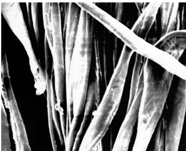
图 2c PVA 上浆的棉纤维经等离子体处理 5min 和一次冷水洗 (放大 700 倍)
